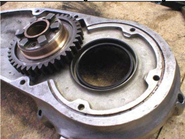
Neue Abdichtung mit Wellendichtring
