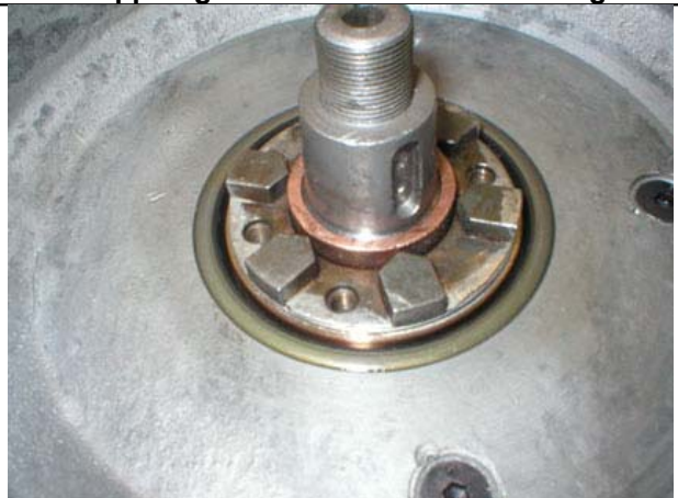
Kupplungsnaabe mit neuer Abdichtung
